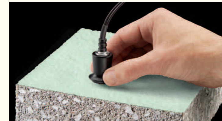
コンクリート、フローリング、パイプ上の厚膜測定
