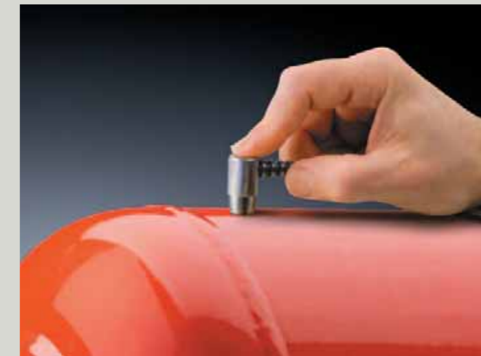
UTG高機能型塗膜通過モデルは塗装上から構造物の厚さを測定し、塗装膜厚を除いた真の肉厚を表示します。
