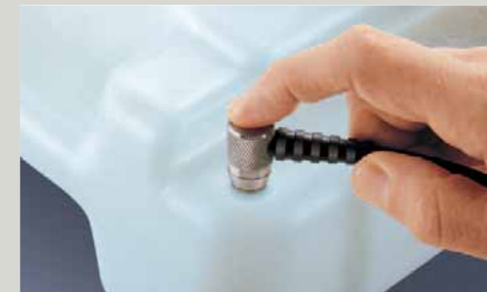
航空機の窓修復工程での航空機窓厚みの測定例
