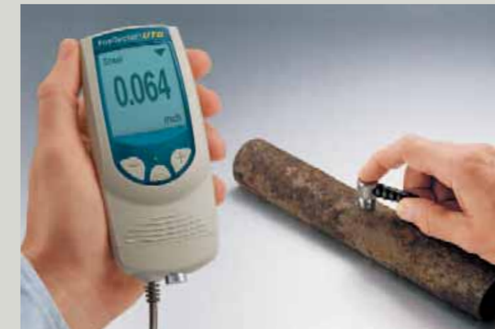
UTG標準型は腐食や磨耗の影響をみるために鋼材、鋳鉄などの残留肉厚を測定します。
